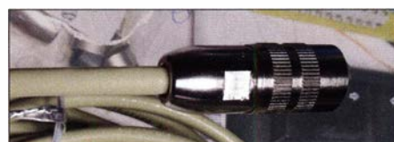
Bild 3: Verbindungskabel mit einem Stecker nach IEC 60130-9
