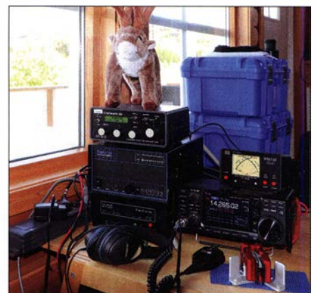
Stationsausrüstung für 1 kW Sendeleistung
