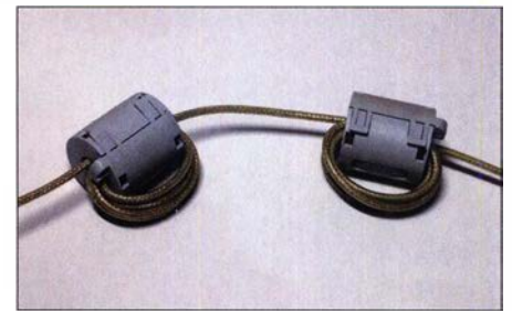
Bild 8: Eigenbau-Mantelwellensperre mit Klappferriten Fotos, Screenshots: DC4KU
