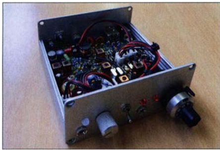
BTR18-SSB mit konventionellem VFO und vierpoligem Quarzfilter Fotos: DK3RED
