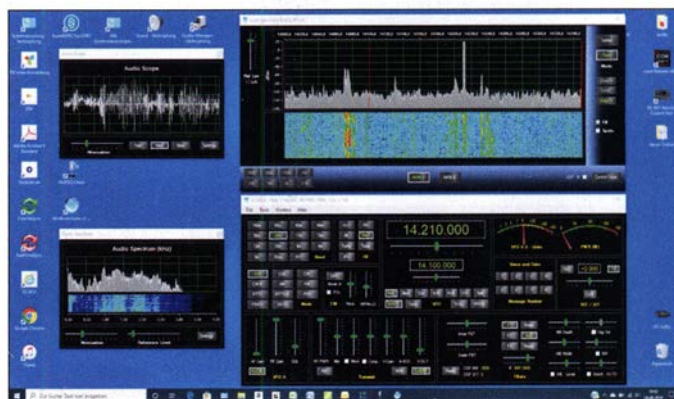
Bild 15: Monitorbild des IC-7300 bei Fernsteuerung übers Internet und mit zusätzlicher Einblendung grafischer Auswertungen des Audiosignals
