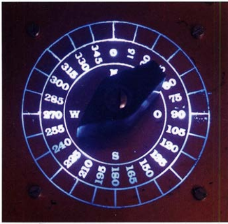
Bild 4: Skale an der Drehrichtungsvorgabe aus geätztem, mit einer Hintergrundbeleuchtung versehenem Leiterplattenmaterial
