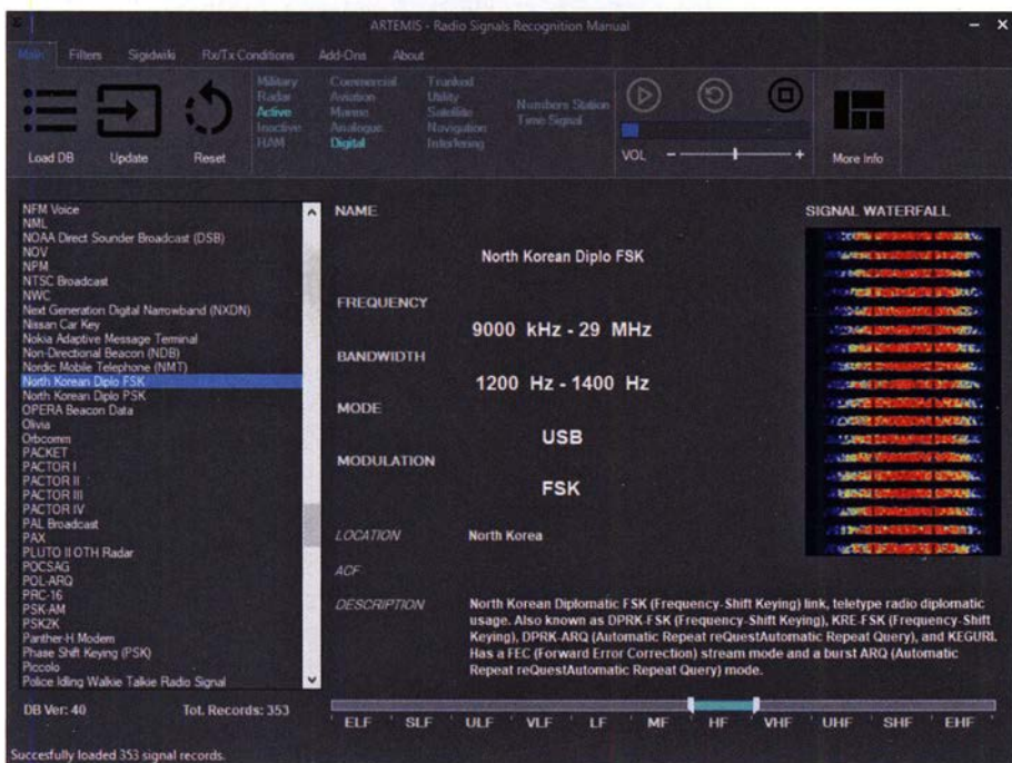
Bild 10: Die Multimedia-Datenbank Artemis (offline) enthält weit über die Hälfte der Sendarten der Web-Datenbank sigidwiki.com, die über das Feld „More Info“ zugänglich ist. Hier ist der Eintrag für eine vom nordkoreanischen Außenamt genutzte FSK-Signalform zu sehen.
