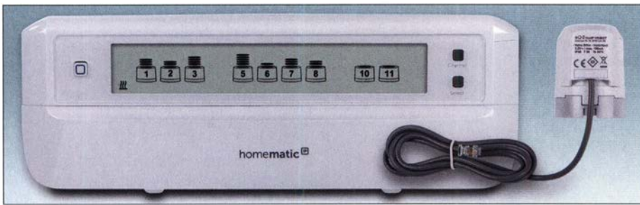
Bild 14: Aktuelle Version der Heizungssteuerung bei Homematic IP; der 12-fach-Fußbodenheizungsaktor steuert motorische Ventilantriebe stufenlos an. Der stromsparende Betrieb erbringt nochmals eine nennenswerte Energieeinsparung, ein aufwendiger hydraulischer Abgleich kann hier zudem entfallen. Fotos, Screenshots: ELV/eQ-3/Schulz
