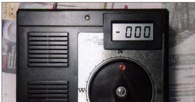
Bild 2: In diesem Steuergerät wurden auch das Gehäuse und der Transformator ersetzt.
