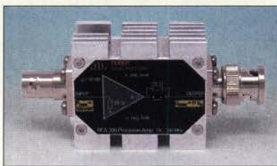
Das Aluminiumgehäuse des RFA300K3G ist mit Kühlrippen und BNC-Anschlüssen versehen.
