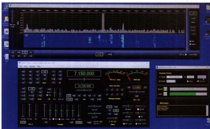
Bild 1: Bedien- und Anzeigefläche des IC-7300 am Notebook während des Fernsteuerbetriebs
