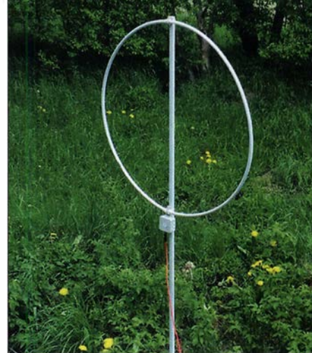
Bild 4: Fertig aufgebaute 160-m-Mini-Loop; eine Aufstellung im Freien ist zu empfehlen.
