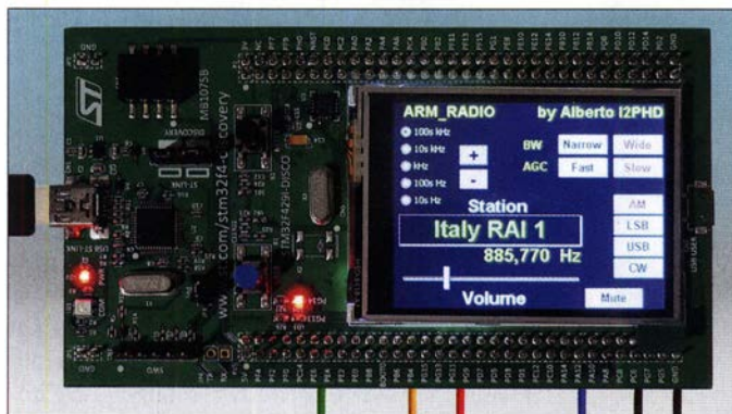
Bild 1: ARM-Radios beim Empfang des AM-Senders Italy RAI I auf 885,77 kHz
