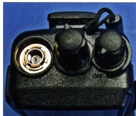
Bild 7: Reverse-SMA-Buchse mit Kanal- und Lautstärkesteller
