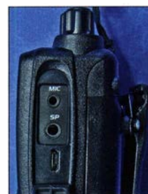
Bild 3: Mikrofon-, Lautsprecher-/Kopfhörer- und USB-Buchse
