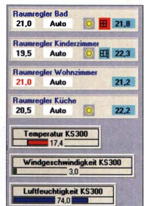
Bild 3: Die Steuer- und Visualisierungssoftware homeputer ermöglichte Übersicht und Steuerung am PC.
