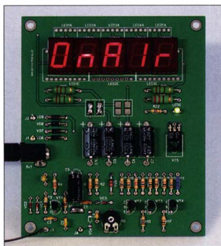
Bild 1: Testaufbau der Sendeanzeige auf einer Musterplatine Foto: FA
