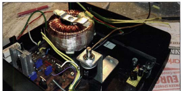
Bild 2: In diesem Steuergerät wurden auch das Gehäuse und der Transformator ersetzt.
