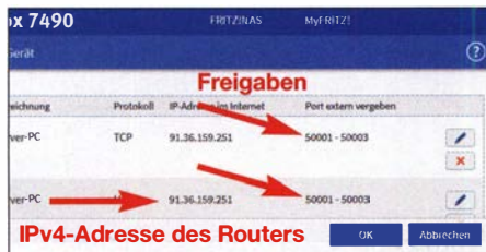
Bild 18: Port-Freigaben im Menü Freigaben einer Fritzbox
