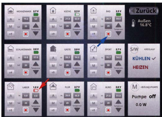
Bild 15: Aktuelle Ansicht der Heizungssteuerung; Symbole geben Auskunft über die Restspannung der Batterien in den Thermostaten – die im Labor ist nahezu leer (roter Pfeil). Außerdem ist der Status der Aktoren erkennbar (blauer Pfeil) – rot bedeutet abgeschaltet.
